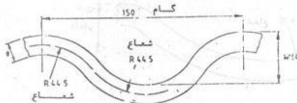
ج - کوره های از نوع فاکس ( با عمق ۴۱ میلیمتر و چین ۱۵۰ میلیمتر )
