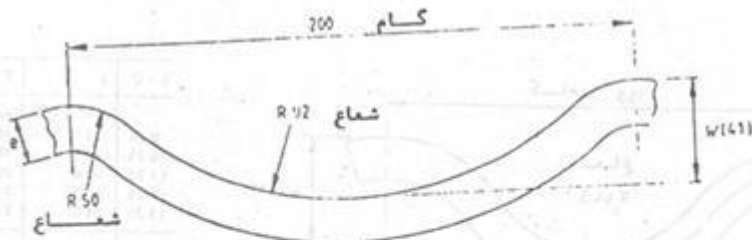
(د) کوره های از نوع مورسیون (با عمق ۲۸ میلیمتر و چین ۲۰۰ میلیمتر)
